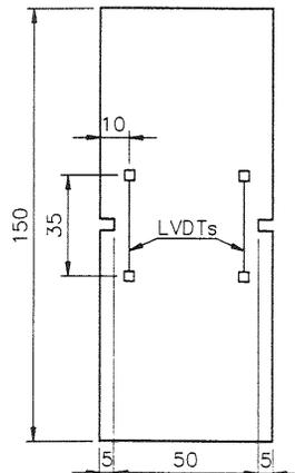
Fig.1. Uniaxial tensile specimen.
