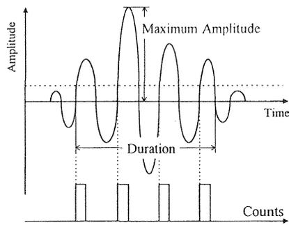
Fig. 6 AE waveform parameters
