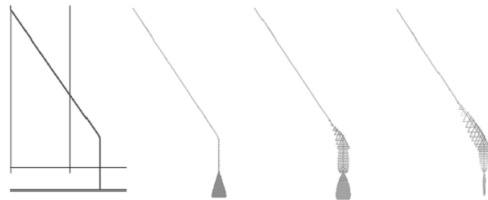
Crack position 65 kN 92 kN 116 kN
