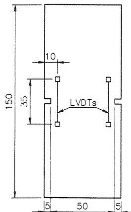
Fig.1. Uniaxial tensile specimen.
