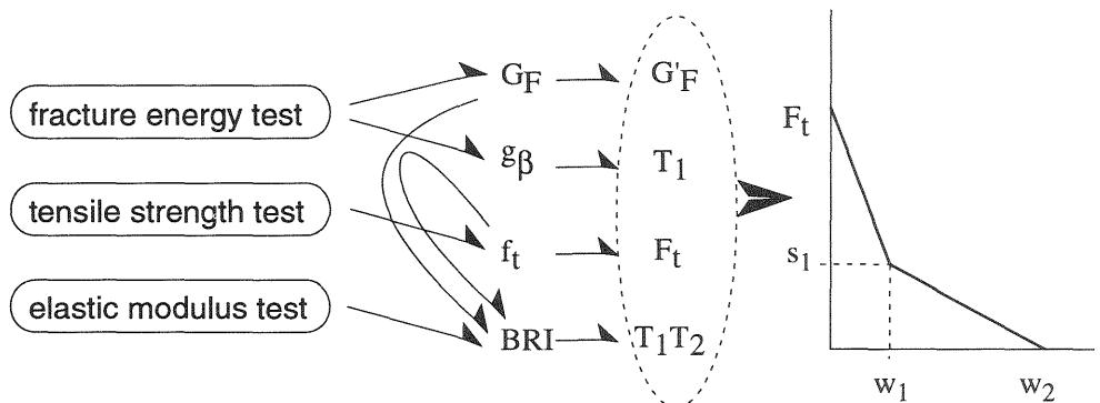
Fig. 2. Procedure to determine parameters
